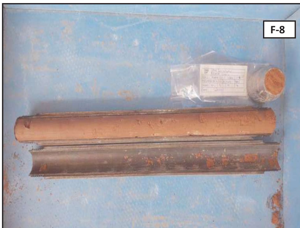
Fotografia 7 i 8: Assaig de penetració SPT-1 i SPT-2 de 2.4 a 3.0 m i de 4,0 a 4,6 m de profunditat respectivament.
