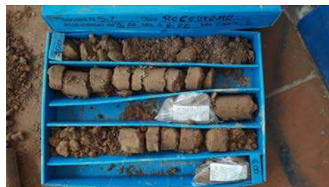
Fotografia 3 i 4: Material recuperat de la perforació.
