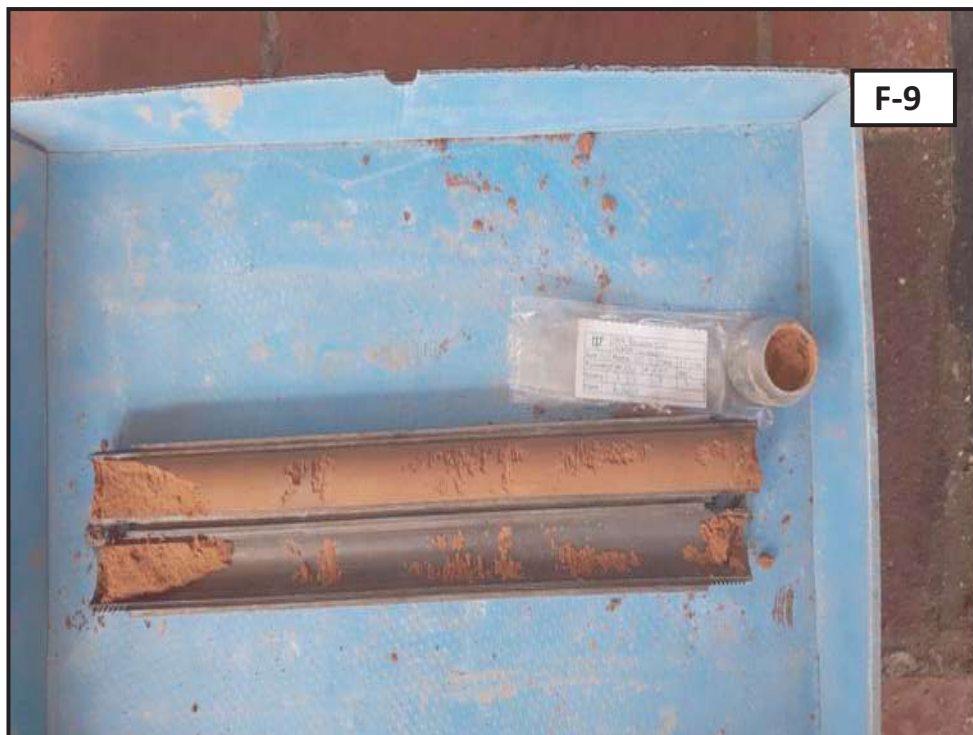
Fotografia 9: Assaig de penetració SPT-3 de 5.4 a 6.0 m.
