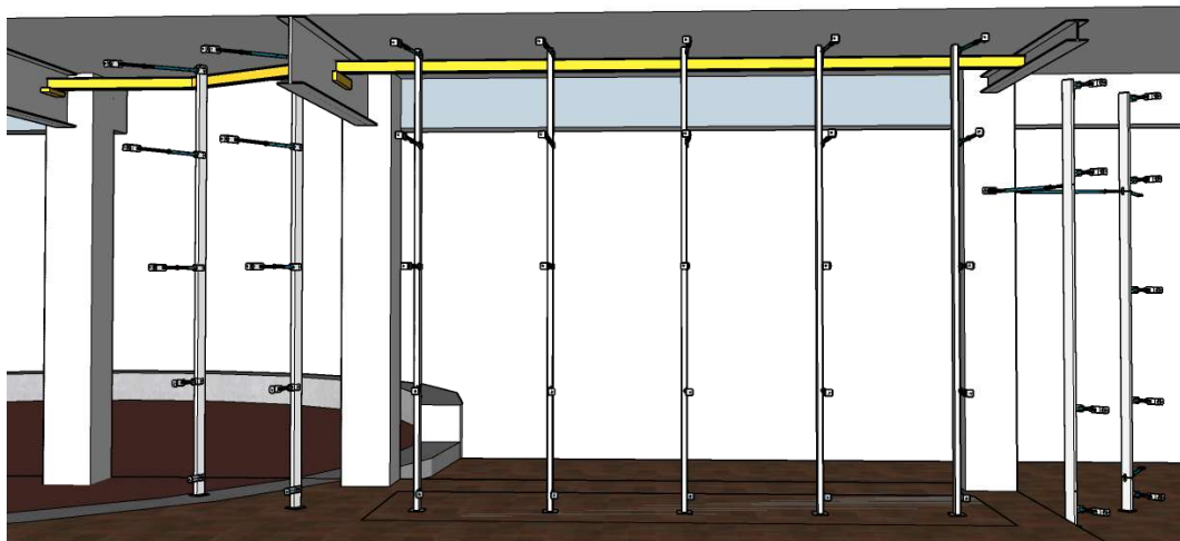
Imagen 2. Sustentación estructura a edificio
